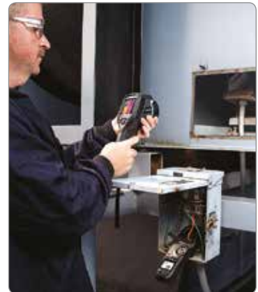
La FLIR CM78 transmite medidas eléctricas en tiempo real a las cámaras IR de FLIR vía METERLiNK.
