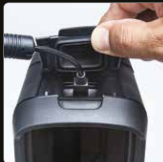
Salida USB para acelerar las descargas de imágenes.
